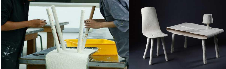
صورة (٢١، ٢٢): نموذج لقطع أثاث مصنعة من ألياف مصاصة قصب السكر مع توضيح طريقة التصنيع.
