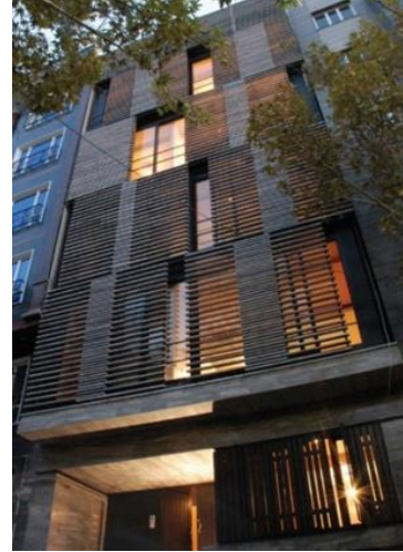
شكل (١٧ & ١٨) واجهة ديناميكية من الشرائط الخشبية المنزلقة، تتحرك بواسطة المستخدم.
