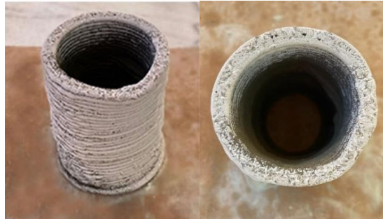
صورة رقم (٥) توضح العينة بعد الطباعة ثم الجفاف وظهور أملاح كربونات وبيكربونات الصوديوم علي سطح الجسم
