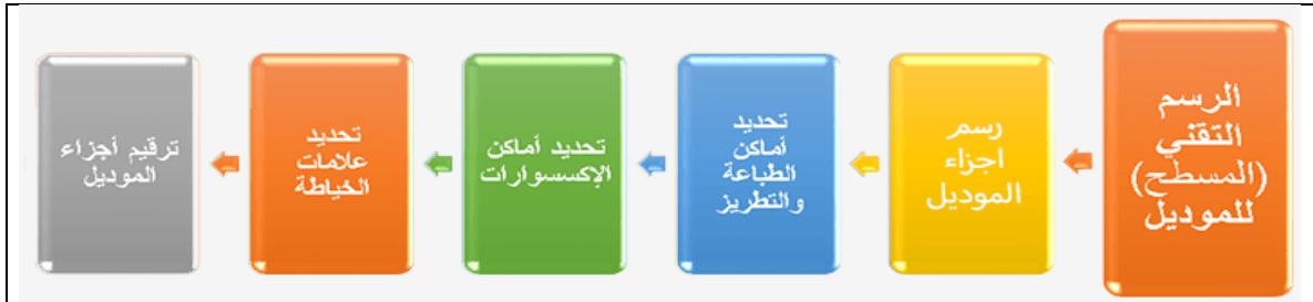
صورة (٧-١) مخطط يوضح الرسم التقني للموديل وما يمر به من خطوات حيث يتم أولاً رسم أجزاء القطعة الملبسية أمام وخلف ثم يتم تحديد أماكن الطباعة والتطريز والإكسسوارات أن وجد وتحديد علامات الخياطة ثم ترقيم أجزاء القطعة.
