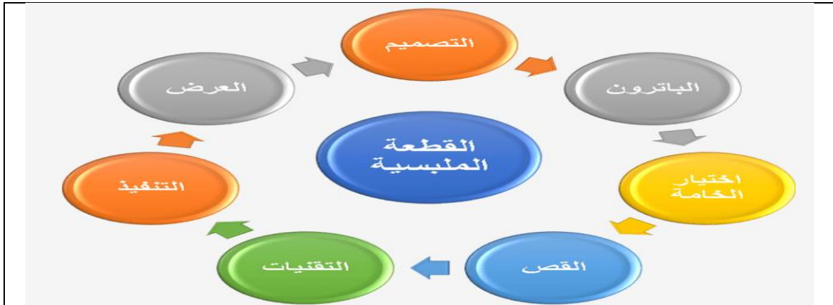
صورة (١-١) مخطط يوضح المراحل الأساسية لإعداد القطعة الملبسية وهي التصميم والباترون واختيار الخامة والقص والتقنيات والتنفيذ (الحياكة) والعرض وكل مرحلة من هذه المراحل تشمل مجموعة من المراحل بداخلها يتم توضيحها في المخططات التالية.
