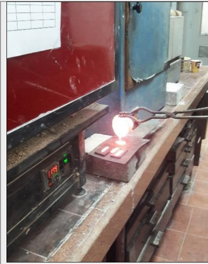
شكل رقم (١٤) يوضح قوالب الاستناليس ستيل أثناء صب المصهور الزجاجي فيها.
