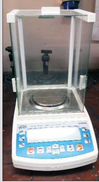
شكل رقم (١٢) نموذج لأحد الأجهزة المستخدمة في وزن المواد الخام الأولية
