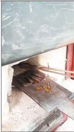
شكل رقم (١٦) يوضح وضع العينات الزجاجية داخل أفران التبريد
