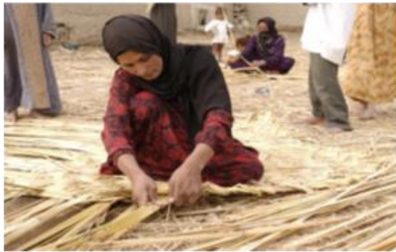
عمل حصر القصب والبردي المحبوكة جيداً التي تستخدم في إكساء الأرضيات الطينية وتغليف أسقف بيوت القصب
