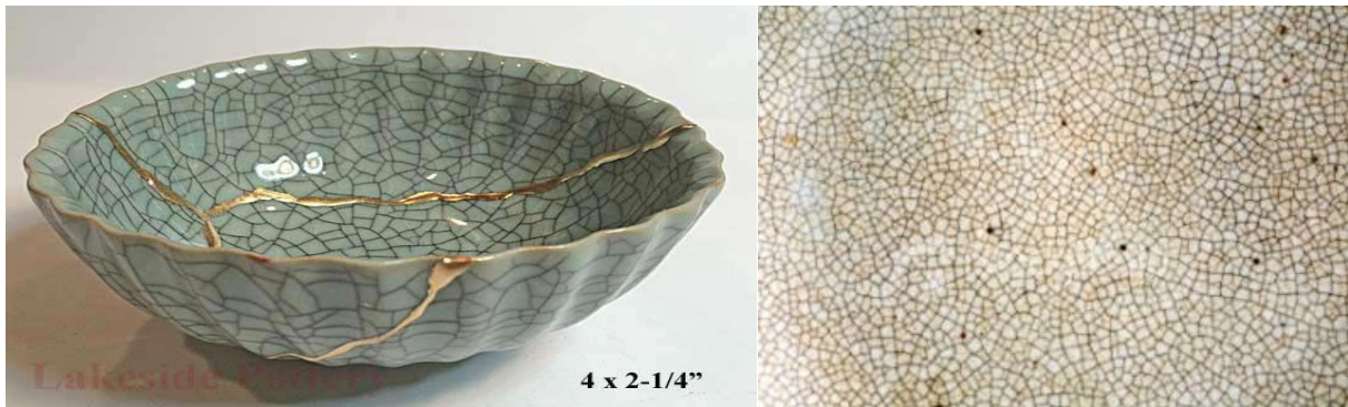
شكل (6) (7) على اليمين نرى ال Crazeing واليسار نرى cracking
