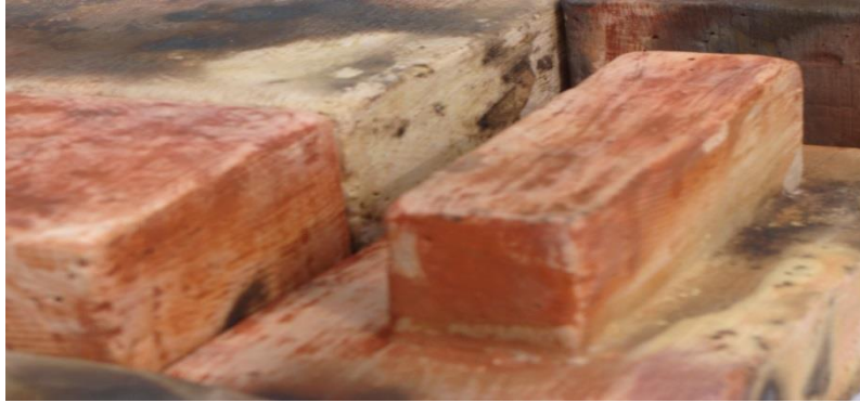
شكل (5) التأثيرات الطبيعية لحريق الحفرة على الجسم الخزفي
