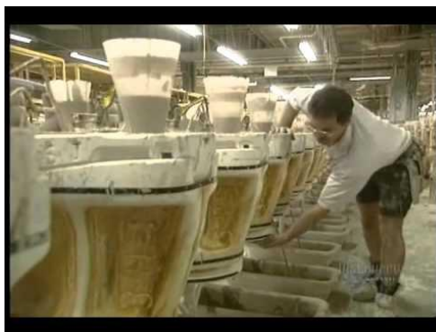
شكل(1) عملية تفرغ القالب من المعلق الطينى
