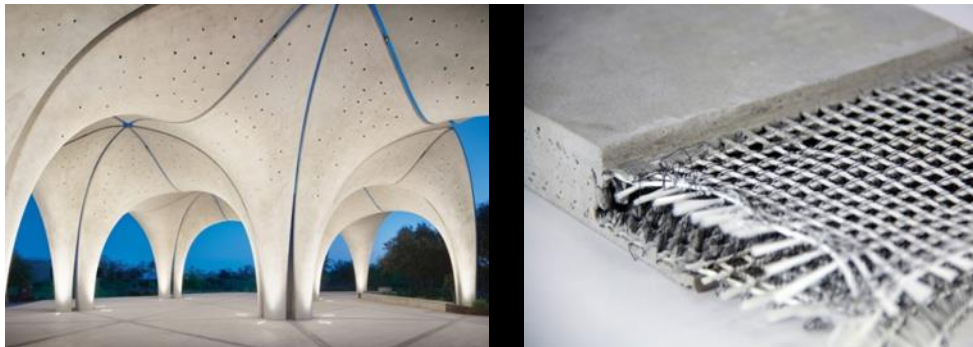
شكل (١٠) الخرسانة المعالجة بالكربون TCFC .
