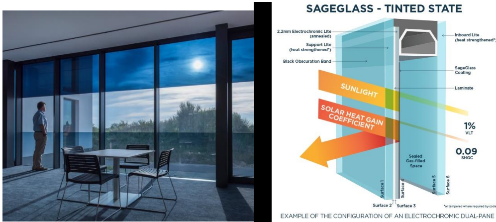
شكل (١٤) يوضح ترتيب الأجزاء المزدوجة المتلونة كهربائيا بوحدات SageGlass و تأثيرها داخليا.
