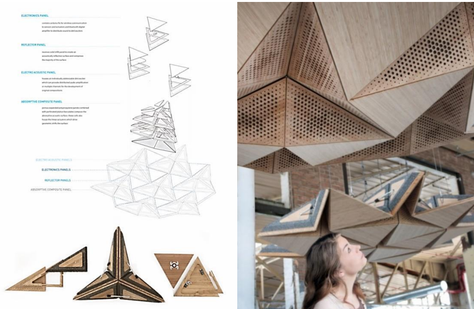
شكل (١٩) التكوين الأوريغامي المثقب لغرف الرنين ذات السطح المغطى بالفيسفساء و ترتيب الألواح بالوضع الأمثل.
