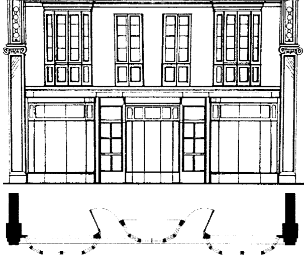
المسقط الرأسي والأفقي يوضح شكل البانوراما الزجاجية في العمارة التراثية بأوروبا.
