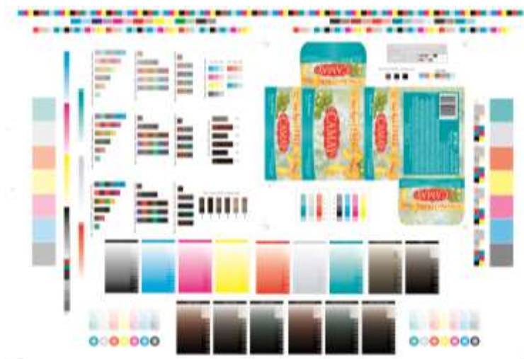
الشكل رقم(6) يوضح الشكل العينة محل التجربة وأشرطة التحكم المختلفة
