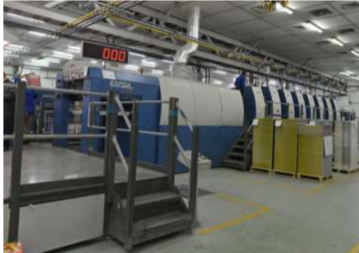
الشكل رقم (5) يوضح ماكينة الطباعة المستخدمة (KBA RAPIDA 106- 7C)
