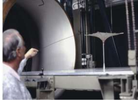
الشكل رقم (14-أ) صورة لتنفق الرياح أثناء عمل الدراسة المحاكية للواقع.
