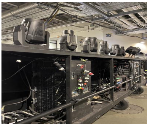
شكل (٢٤) العربات الميدانية المتحركة وهي مجهزة وفوقها Series 400 بنظم توزيع الطاقة والبيانات وحدات الإضاءة
