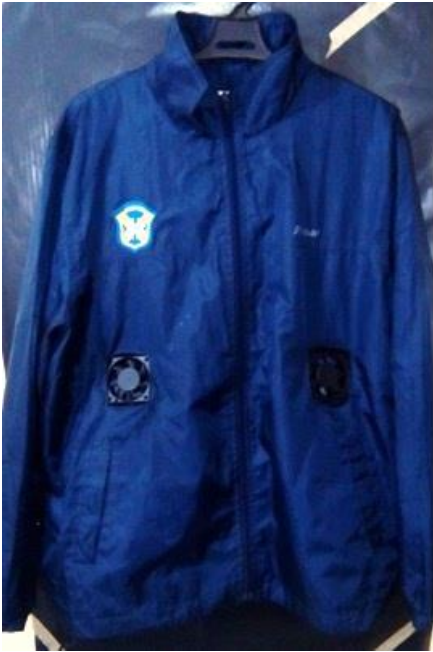
صوره (١٣) شكل الجاكت بعد اضافته مراوح التبريد
