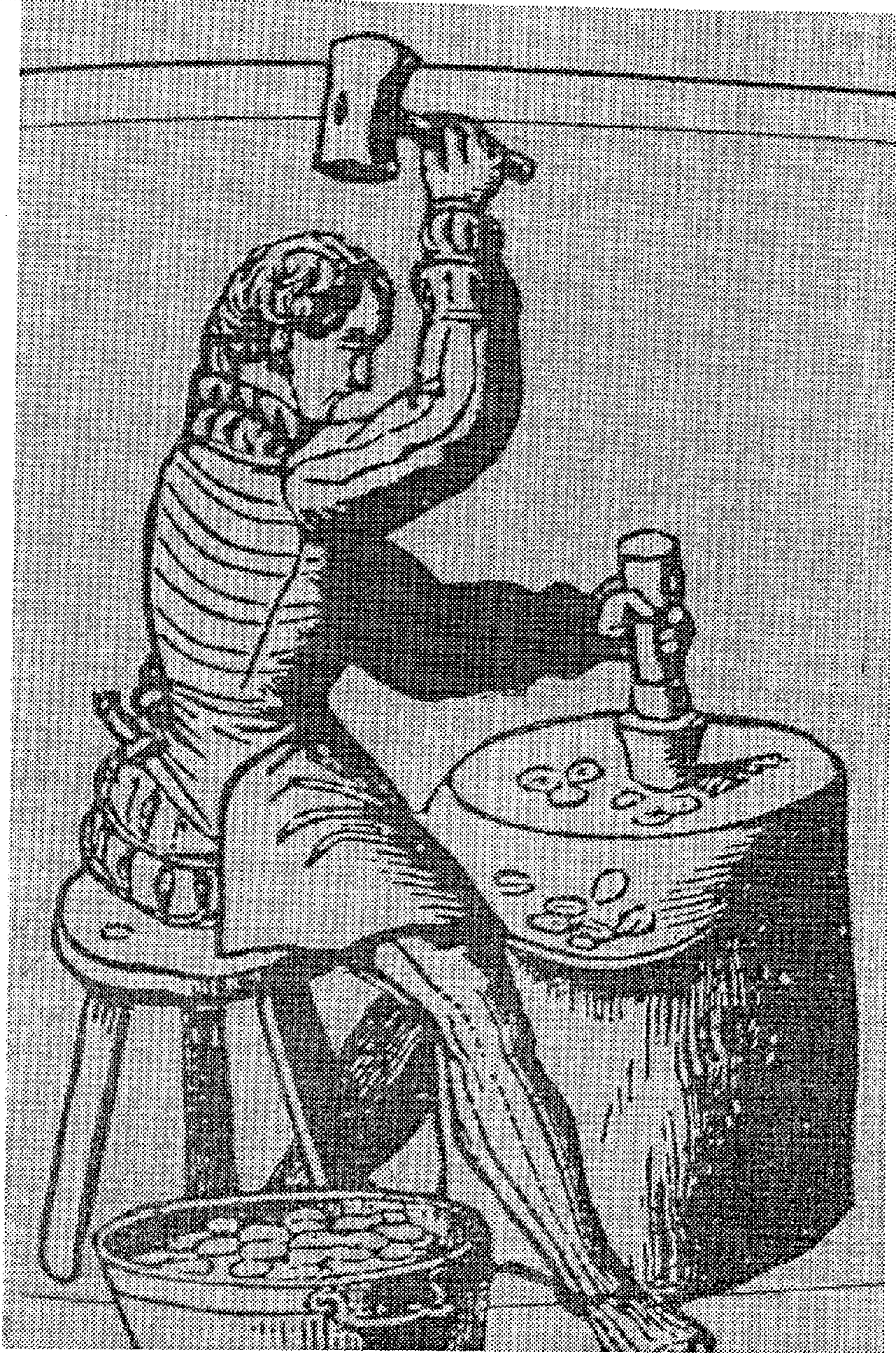
شكل ٧٠: رسم لصانع يقوم بإنتاج النقود حيث يقوم بضرب الأقراص بين القالبين ليحولها إلى نقود، ويلاحظ قطع النقود التي تم ضربها، والإتاء الموجود بجوار الصانع والمملوء بالنقود. شمس إشراق: ص ١٦.
