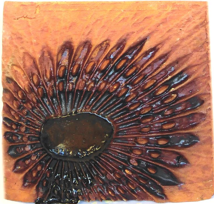
صورة رقم (٧) أحدي القطع الخزفية المنفذة بطريقة الحفر على وجهي القطعة باستخدام ماكينة تحكم رقمي بثلاث محاور لأحد التصميمات المنفذة على الحاسب والمشار إليها في صور سابقة وتم التنفيذ على كتلة جافة من طينة أسوان الحمراء وتم حرق القطعة حريق أول, وحررق ثاني لتطبيق الطلاء الزجاجي, وتتراوح أبعاد القطعة (٣٠سم طول * ١٥سم عرض * ٤سم ارتفاع)
