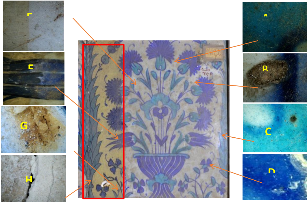
لوحة رقم (١) توضح الفحص والتصوير بالميكروسكوب الرقمي للبلاطة الخزفية رقم (١) بمتحف الفن الإسلامي قوة التكبير 250 \times
