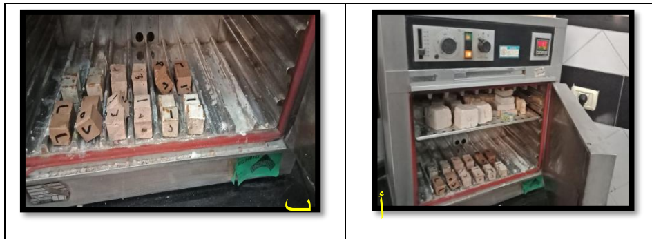
لوحة رقم (٢) توضح العينات أثناء إجراء عمليات التقادم الحراري ( أ ، ب ) في فرن التقادم الحراري في مركز بحوث الإسكان والبناء
