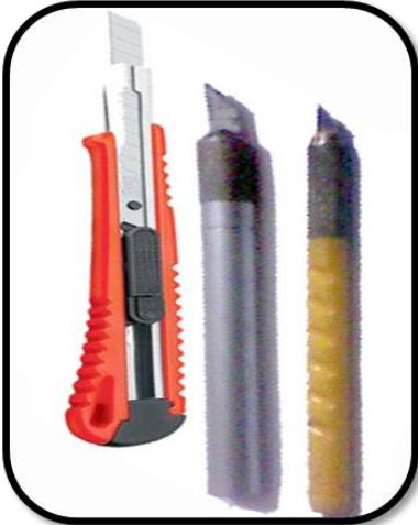
يستخدم لتفريغ الأجزاء المراد تفريغها في الاسطامبا و له أشكال كثيرة ولكن الهدف من استخدامها واحد وهو تفريغ الزخارف وفضل انواعه لتفريغ الاستنسل الأسطوانية التي تشبه القلم ولها اطراف حادة قاطعة تشبه سنون القلم وهي اكثر دقة غى عملية التفريغ.
