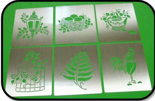
وهي صفائح المعدن الرقيقة كالنحاس أو الزنك أو الصفيح ( وذلك لتكون أكثر تحملا عند الطباعة المتكررة.
