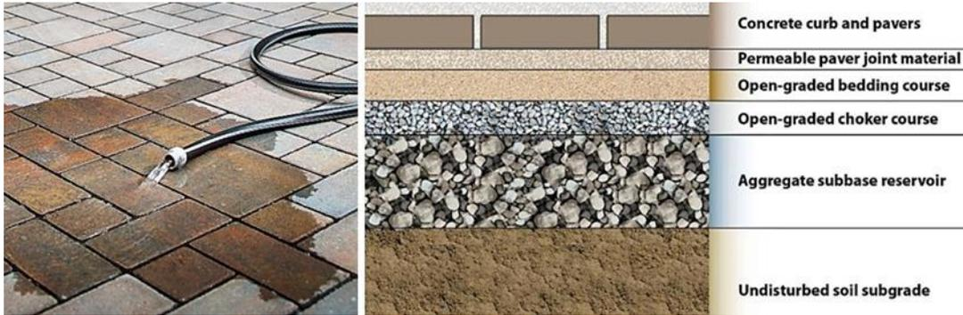
شكل (٨): يمين (طبقات الأرصفة الخرسانية المتشابكة النفاذة)، يسار (الأرصفة الخرسانية المتشابكة النفاذة أثناء التعرض للماء)
