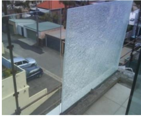
شكل رقم (-) يوضح الزجاج مع طبقة PVB يوضح الزجاج المصفح في حالة الكسر
