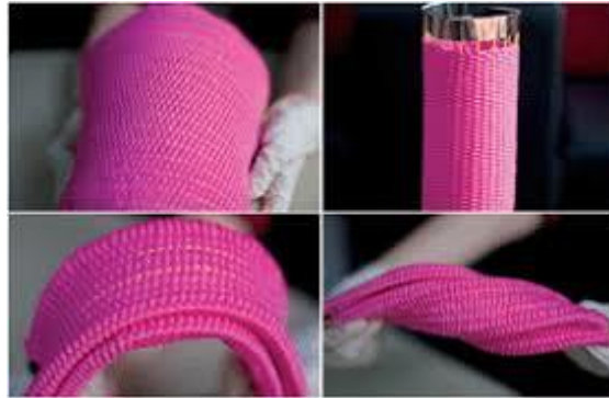
شكل (٦) بطارية ليثيوم أيون مائية جديدة على شكل ألياف (Zhang et al., 2016)
