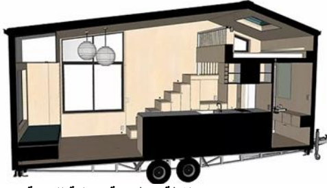
صورة 3: توضح توضح لقطة منظورية داخلية للكيبنة دور علوي واحد للنوم فوق المطبخ، يمكن الوصول إليه بواسطة سلالم مخصصة.
