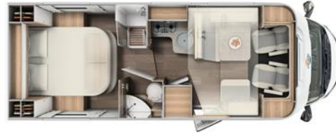
صورة ٤: المسقط الأفقي لكيبنة ذاتية السحب، يقدر حجم الفراغ الداخلي ٧.٤ × ٢.٣٢ × ٢.٩٠ م، تكفي ل ٤: ٥ أفراد.
