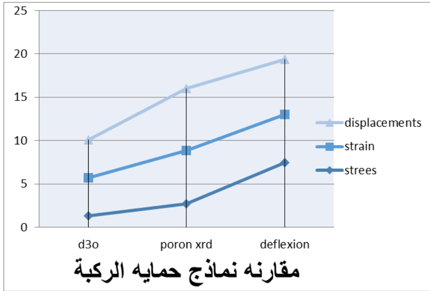
شكل (٢٦) نتائج اختبارات نماذج حمايه الركبه وزن ٦٠ كجم ارتفاع ٨ متر
