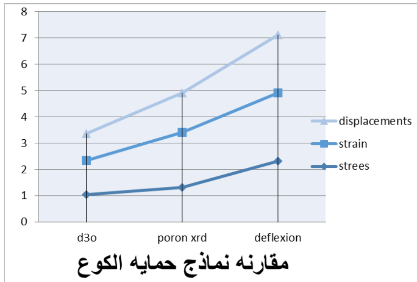
شكل (٢٢) نتائج اختبارات نماذج حمايه الكوع وزن ٦٠ كجم ارتفاع ٨ متر
