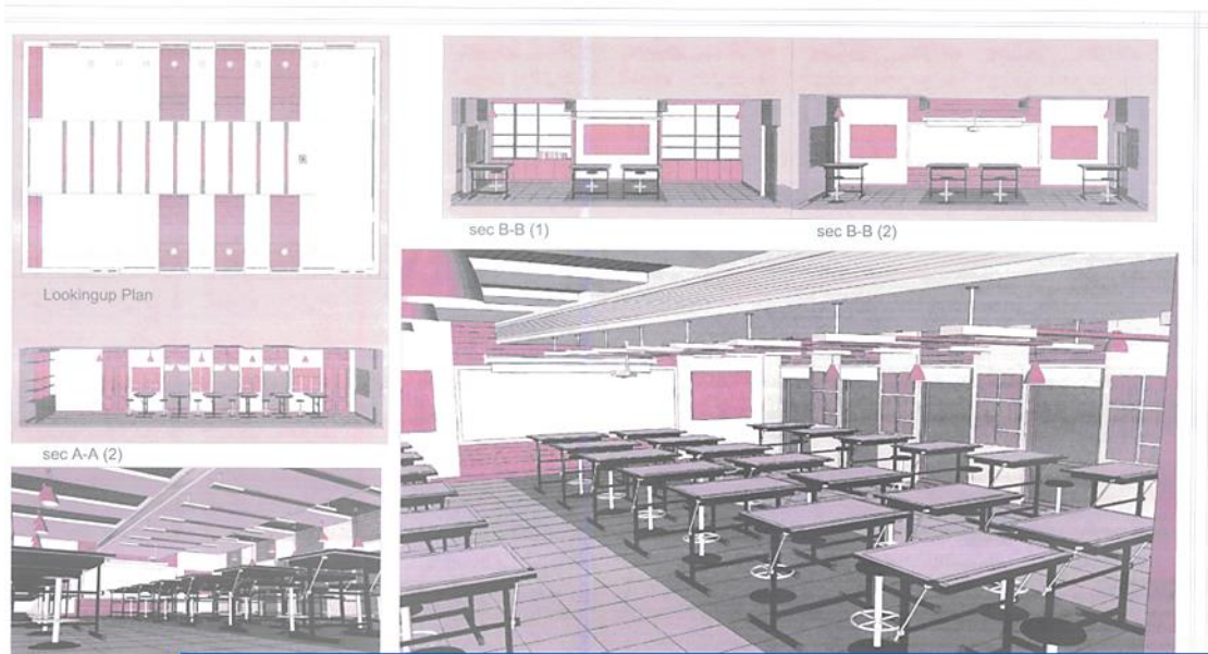
شكل (١٥) معالجات الأسقف لتوفير الأضاءة المناسبة الكافية لكل طالب بالمرسم. ( من تصميم الباحثه )
