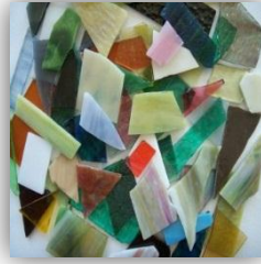
شكل ( 22 ) يوضح فاقد الزجاج المسطح الملون الذي يمكن الاستفادة منه باعادة تشكيله حراريا
