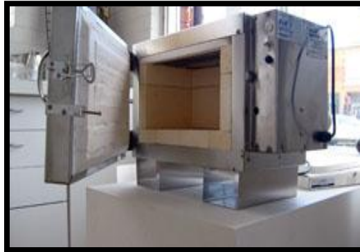
شكل (16) لأحد الأفران الكهربائية المستخدمة في أساليب إعادة تشكيل الزجاج حرارياً
