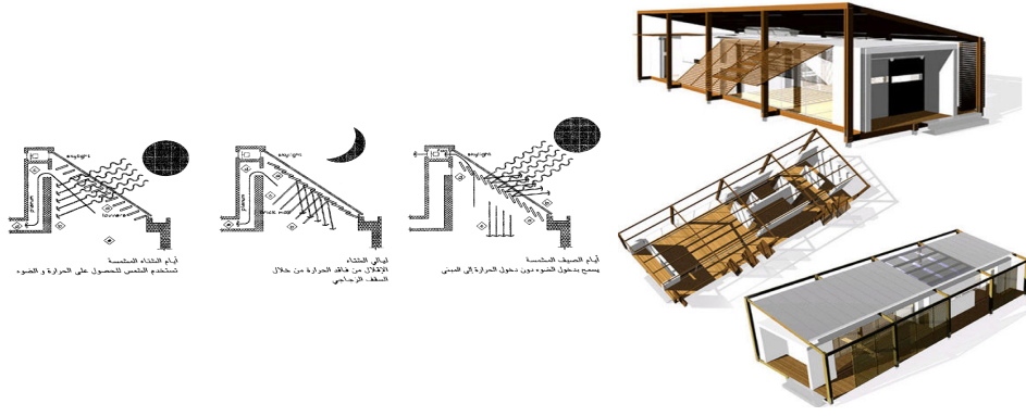
شكل (7) استخدام كاسرات الشمس المتحركة للتحكم فى التعرض لأشعة الشمس
