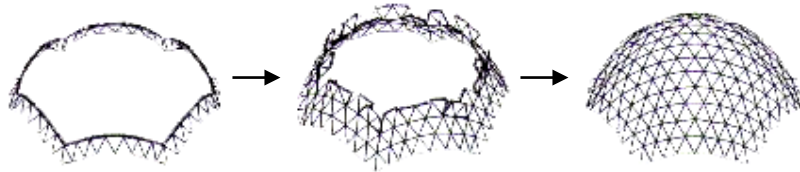
( شكل 23 ) نموذج لمظلة ذات نظام منتشر يمكن ان تتخذ عدة أشكال تبعاً للمعلومات الآتية من المجسات المتصلة بنظام التحريك 0
