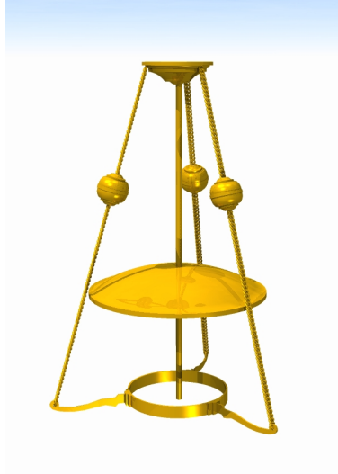
شكل رقم 28 الأجزاء النحاسية لتعليق المشكاة الزجاجية
