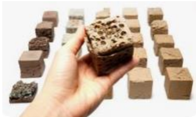
شكل 12: رمال الصحراء منخفضة الكربون.
