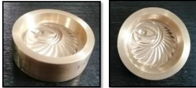
شكل (19) الشكل النهائي للقالب النحاس بعد عمليات التشطيب
