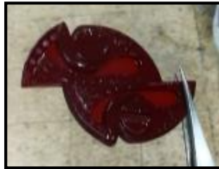
شكل (11) النموذج الشمعي بعد خروجه من ماكينة الطباعة مباشرة
