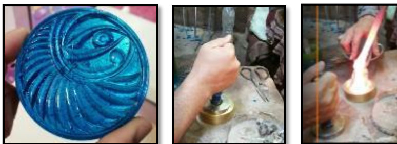
شكل (21) قطعة الحلي الزجاجية أثناء وبعد عملية التشكيل من المصهور الزجاجي بالكبس
