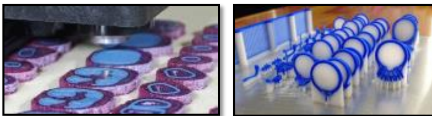
شكل (4) نماذج من الخواتم توضح الأجزاء الداعمة وتظهر بلون مختلف عن النموذج ليتم إزالتها بالمذيبات
