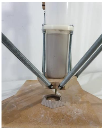
صورة رقم 6 توضح الوحدة أثناء الطباعة
