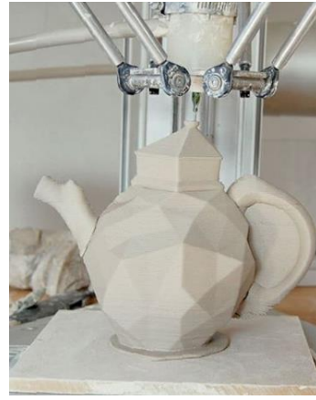
صورة رقم 3 توضح براد خزفي للفنان Johanthan Keep منتج بواسطة ماكينات ثلاثية الأبعاد يوضح هياكل الدعم في يد البراد (8)
