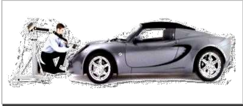
صورة رقم (2)عملية مسح ضوئي لسياره وتحويلها لنموذج رقمي
