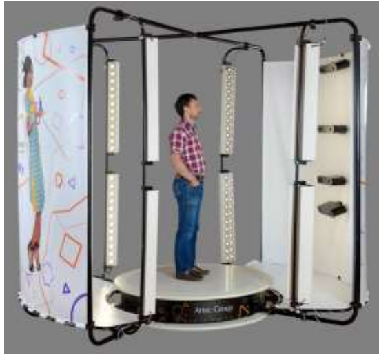
صوره رقم ( 3 ) المسح الضوئي لجسم الانسان Artec Shapify Booth
