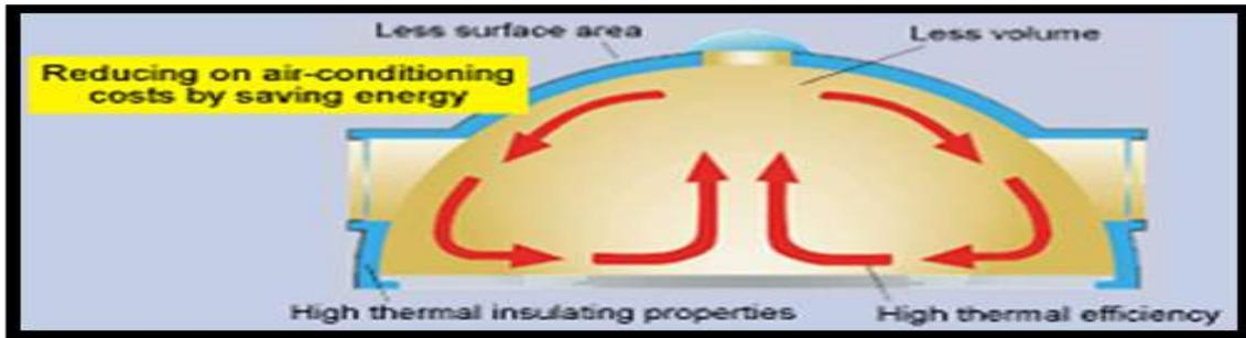
شكل ( 4 ): حركة الهواء الساخن في القبه والاحتفاظ به، شكل قباب الحمام بارزه على مستوى سطح الأرض
