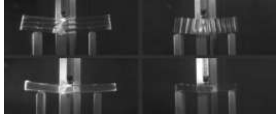
شكل (16) يوضح اختبار الصدمة للزجاج ثلاثي الابعاد المطبوع بالطابعه G3DP
