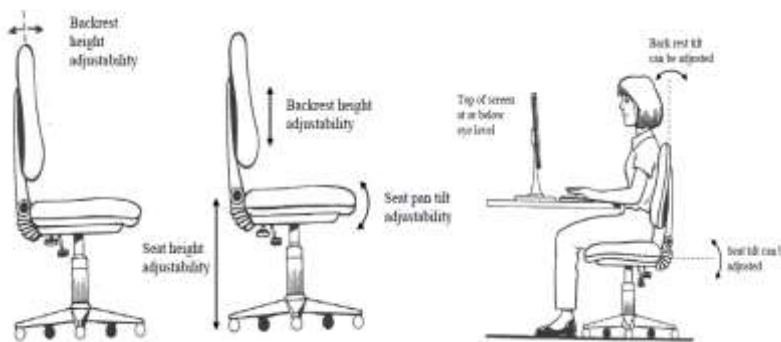
شكل ( 2 ) قابلية الكرسي الأرجونومي للضبط
